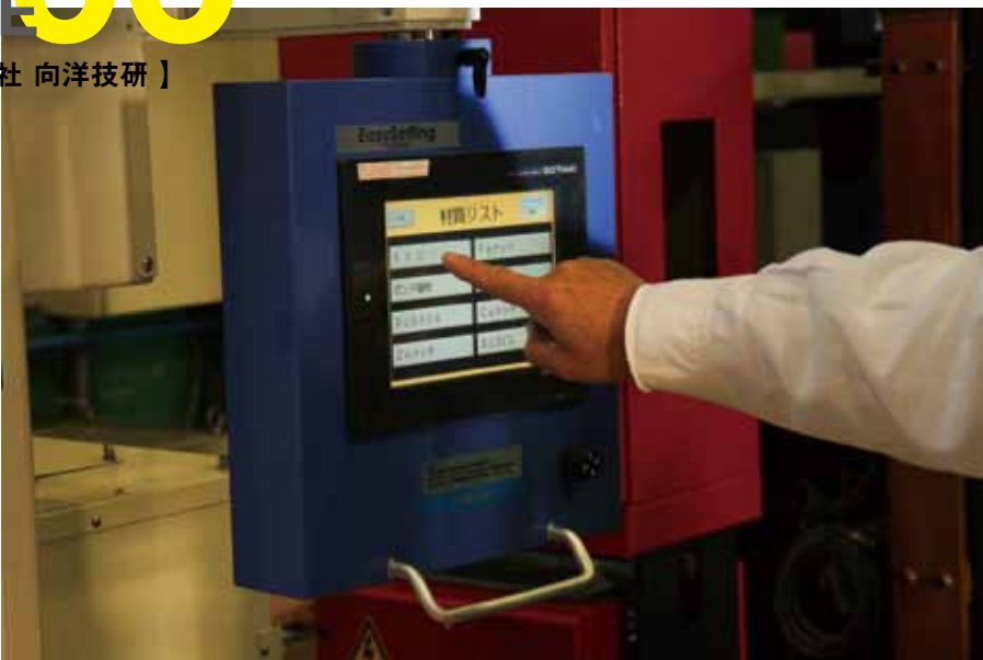
溶接する板厚と材質をタッチパネルで選ぶだけで最適な溶接条件が自動で設定される「イージーセッティング機能」。誰でも簡単に美しい溶接を実現させた。
