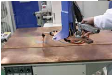
下部電極が銅板テーブルの特長。そのためスポット圧痕が極少になり、ワークを苦勞してひきずることなく作業できるため作業効率も格段に向上するという。
