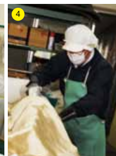
③布団でいうと中に詰める綿に相当するグラスウールを、図面に基づいてカットしてい く。④カットしたグラスウールを袋状のシートへ組み込み、ファインジャケットに必要な それぞれのパーツを作成する。⑤複数のパーツを組み合わせて、ビルや工場のバルブの形 状に立体的に合わせたファインジャケットが完成。
