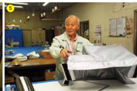
③布団でいうと中に詰める綿に相当するグラスウールを、図面に基づいてカットしてい く。④カットしたグラスウールを袋状のシートへ組み込み、ファインジャケットに必要な それぞれのパーツを作成する。⑤複数のパーツを組み合わせて、ビルや工場のバルブの形 状に立体的に合わせたファインジャケットが完成。
