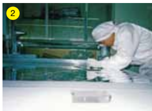
①～③人工衛星「はやぶさ」のサーマルブランケット（外部から衛星内に入ってくる熱を遮断するもの）は、高い集中力と緻密な精度が要求される職人の技で縫製されていく。このサーマルブランケットは、クロスメディア内の特別な別室で製作されている。
