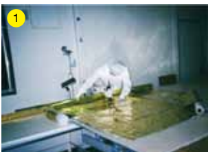
①～③人工衛星「はやぶさ」のサーマルブランケット（外部から衛星内に入ってくる熱を遮断するもの）は、高い集中力と緻密な精度が要求される職人の技で縫製されていく。このサーマルブランケットは、クロスメディア内の特別な別室で製作されている。
