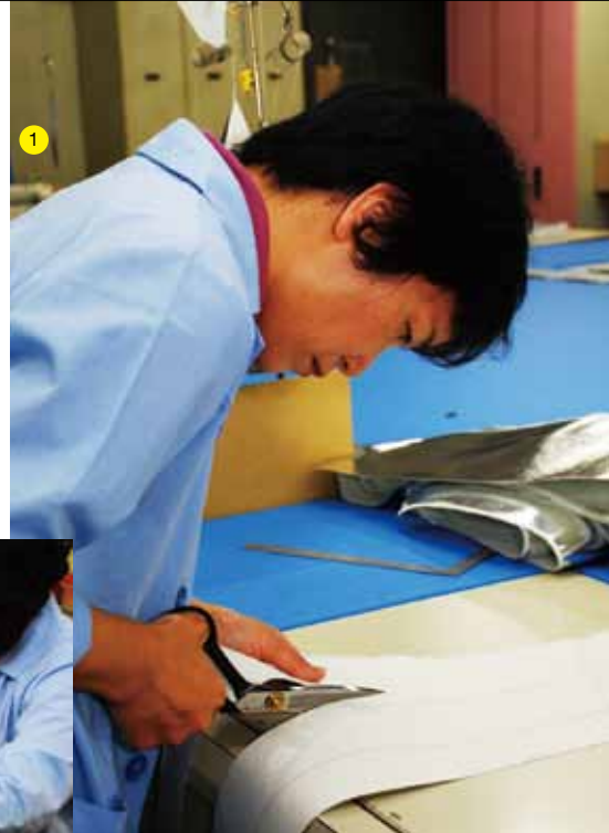
①ファインジャケット製作の様子。図面に 基づき、表面シートを正確に裁断してい く。②ファインジャケットのパーツを袋状 に縫製する。ガラス繊維の糸を、高出力 のミシンで縫いあげていく。
