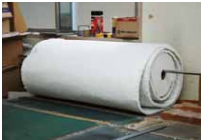
ズッシリとした重量感のあるホワイトグラスウール。これをファインジャケットの形状にカットする。
