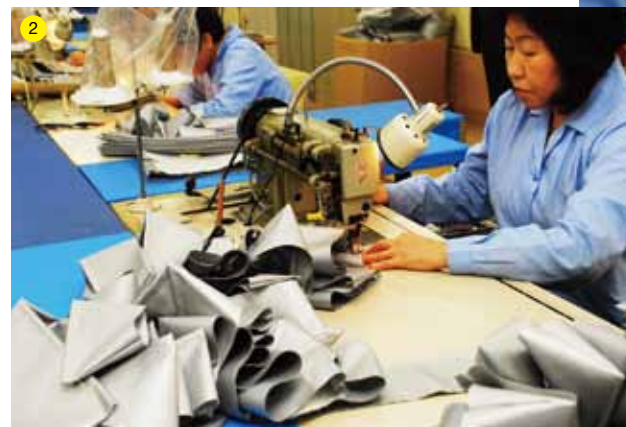
①ファインジャケット製作の様子。図面に 基づき、表面シートを正確に裁断してい く。②ファインジャケットのパーツを袋状 に縫製する。ガラス繊維の糸を、高出力 のミシンで縫いあげていく。
