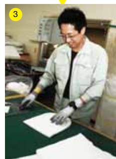
③布団でいうと中に詰める綿に相当するグラスウールを、図面に基づいてカットしてい く。④カットしたグラスウールを袋状のシートへ組み込み、ファインジャケットに必要な それぞれのパーツを作成する。⑤複数のパーツを組み合わせて、ビルや工場のバルブの形 状に立体的に合わせたファインジャケットが完成。
