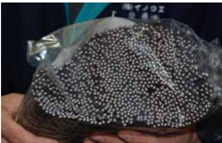
リング状に接着される前の切りそろえられた「ゴムひも」。1カ月に200万本ものヘアゴムが生産され、それらは人の手の微妙な感覚を活かして接着されヘアゴムになる。
