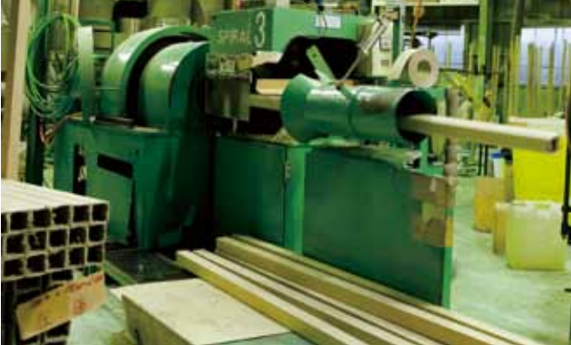
前ページの火力で接着する機械から出てくるスパイラル工法の角紙管の誕生。表彰状を入れる筒入れなどにも使われている。
