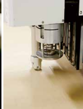
(写真右) CADと連動したダンボールのオートカッティングマシン。この機械だけで複雑な曲線も含めての紙の裁断が可能。 (写真左) 従来からのスパイラル工法での角紙管の製造。角形の型に再生紙を巻きつけ火力を使って紙の接着を強化する。
