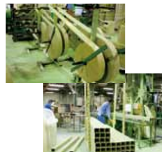
金属の型に巻きつける再生古紙を送り出す工場風景。手前円筒状の再生古紙が型に巻きつけられて角紙管が製造される。
