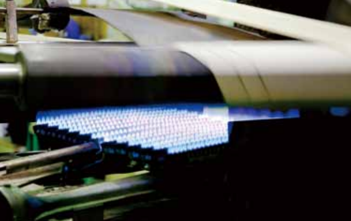
(写真右) CADと連動したダンボールのオートカッティングマシン。この機械だけで複雑な曲線も含めての紙の裁断が可能。 (写真左) 従来からのスパイラル工法での角紙管の製造。角形の型に再生紙を巻きつけ火力を使って紙の接着を強化する。
