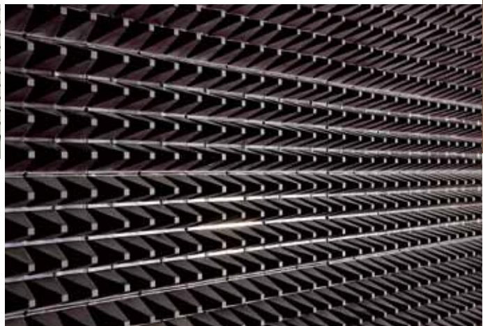
EMC試験を実施する電波暗室では、発生した電波の反射を抑えるため、壁面に多くの電波吸収体を備え、障害物のない屋外空間を再現。
