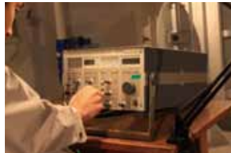
業務には高価な測定器が不可欠。（写真下）上限周波数が40GHzまで測れるテストレシーバー。
