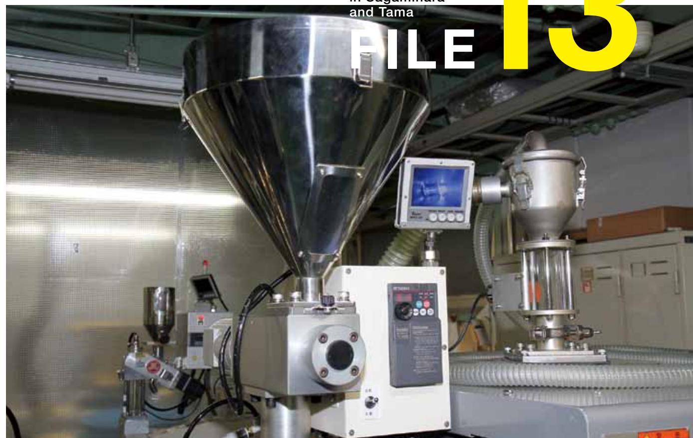
成形機に原料を定量供給する「ハングリー・フィーダ」。自然供給によるスクリュ・シリンダへの負担という課題を解決した。
