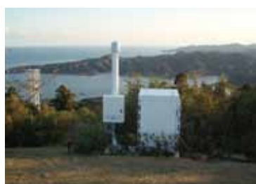
(写真右) 北は北海道・稚内から南は沖縄・石垣島までの全国30カ所で落雷を計測しているセンサーの配置図。(写真左) 長崎県対馬に設置しているセンサー「LS7001」。
