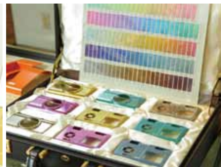
カラフルなチタン製デジタルカメラカバーの試作品。1個の簡易型のみで、マグネシウムやチタンを絞る加工技術は、2002年度の厚生労働大臣賞を受賞している。
