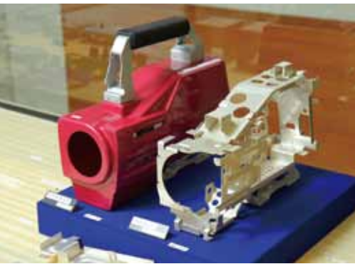
難加工材のマグネシウム合金を、放送用VTRカメラのフレームに使用した試作品。この技術で、高硬度で軽量のVTRカメラが実現できるようになった。
